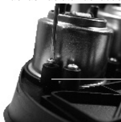
3. Buchas não atarrachadas
